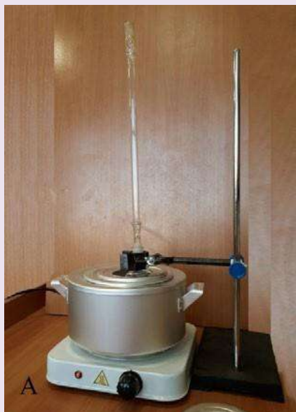
Рис. 6. Баня комбинированная лабораторная. А — водяная баня. Б — песчаная баня
