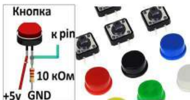
Рис. 1. Схема подключения тактовой кнопки к микроконтроллерной плате
